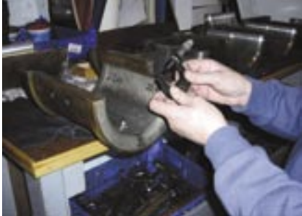
Blytråden i lagret mäts med micrometer.
